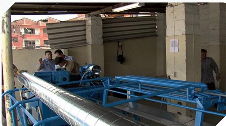
شکل ۴: دستگاه تولید و برش لوله‌های گالوانیزه از ورق گالوانیزه که در کارگاه مستقر می‌شود.
